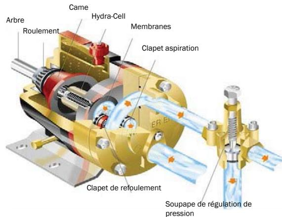
La pompe Wanner Hydra-Cell est parfaitement adaptée aux liquides faiblement visqueux, non lubrifiants, très abrasifs, chargés ou corrosifs. Son entretien minimum est garanti pour un usage industriel intensif.
