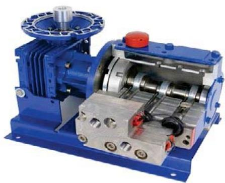
Les pompes doseuses série P sont équipées de réducteurs de vitesse intégrés afin d'ajuster leurs débits aux besoins des utilisateurs. Équipées de variateurs de vitesse, ces pompes représentent une alternative économique, performante et sans pulsation face aux pompes doseuses classiques.
