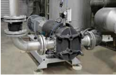
Pompe à lobes ONIXLine destinée au pompage de l'amidon
