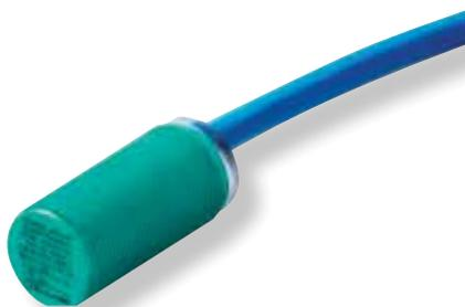
Le détecteur compte chaque mouvement des membranes (coups). Le débit peut être déterminé en multipliant les nombres des coups par le volume de la chambre côté fluides. Les senseurs sont localisés dans le bloc central et à chaque fin de course ils donnent un signal électronique au boîtier de contrôle.
