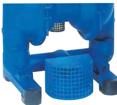
Les pompes pneumatiques à double membranes DEPA® de la série M peuvent être équipées d'une crépine montée sur le collecteur d'aspiration afin de filtrer les liquides chargés. Pour toutes les pompes, les crépines sont disponibles en acier ou acier inoxydable.
