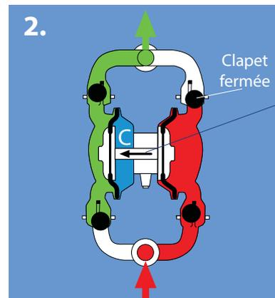
L'air comprimé de la chambre C agit sur la membrane afin de faire sortir le produit de la pompe.
