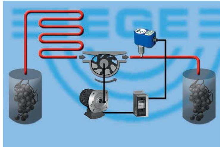
Un détecteur contrôle le débit et la température dans une pompe à roue pour le moût de vin (fabrication de vin)
