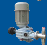
Pompe type RCN 6 A 70 TL Débit maximum 500 ml/h Pression maximum 40 bar Réglage du débit par incrémentation de 1%.
